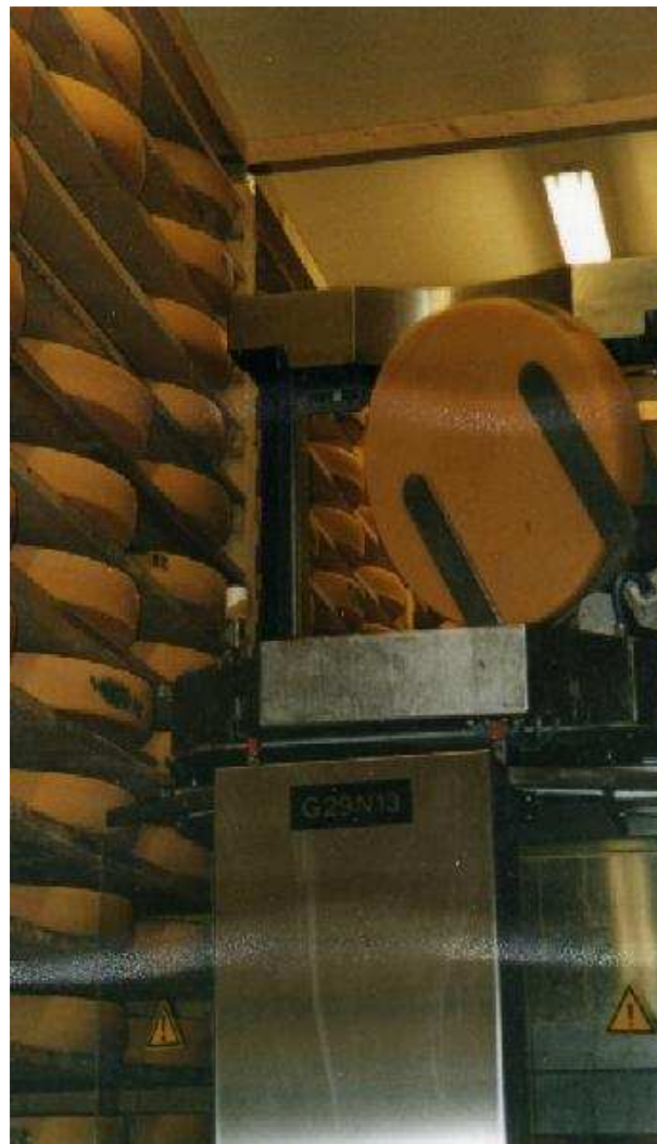
FIG. 5.15: Retournement d'une meule par un robot
